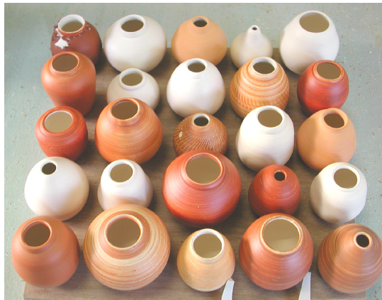
Essais d'enduits sur terre à faïence tournée cuisson oxydante
